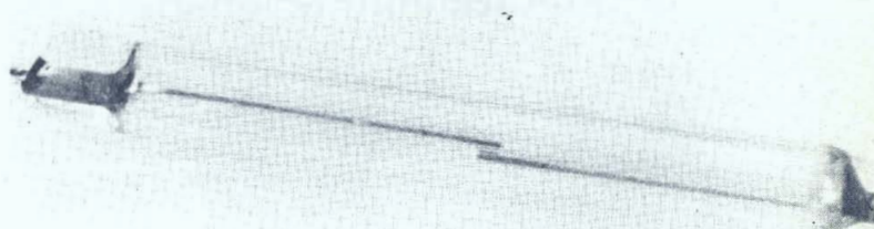
Immagine scattata con obiettivo macro di un interruttore a lame sottili. Si noti l'esigua distanza delle lame.
